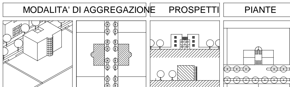
UNITA' EDILIZIA SUL FILO STRADALE
